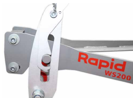
In Transport- oder Verladestellung, Wiesenschlepe fixiert
