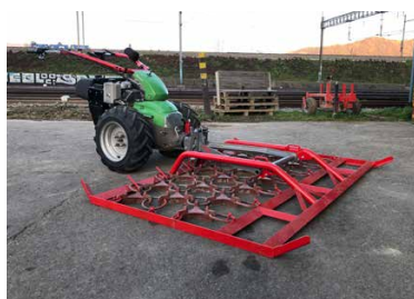
Gezogenes Anbaugerät Durch den konzeptionellen Aufbau der Wiesenschlepe wird bequem gestossen-gezogen in Vorwärtsrichtung gearbeitet werden.
